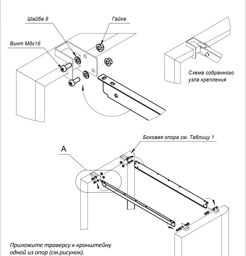
Соедините траверсу с кронштейном опоры при помощи винтов М8х16 через шайбы 8 и стопорные гайки М8. Гайки должны быть с внутренней стороны опоры! Повторите со второй траверсой.
